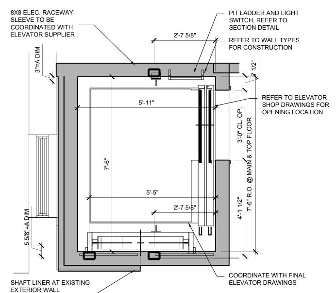
T ENLARGED PLAN - TYPICAL ELEVATOR
