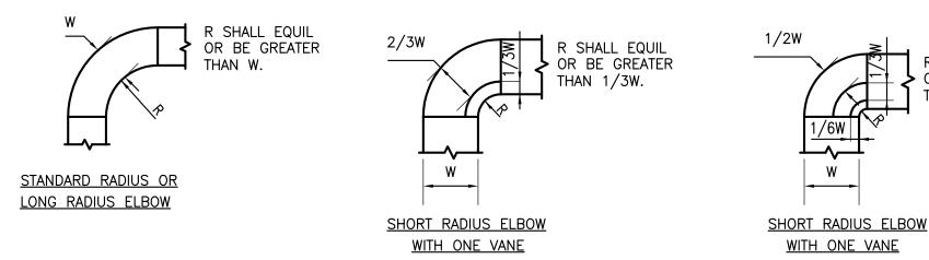
1. THE INTERIOR SURFACE OF ALL RADIUS ELBOWS SHALL BE MADE ROUND.
